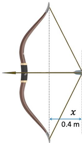
3- أستخدم الأرقام: صنع فراس قوسًا خشبيًا، وثبت فيه وترًا، كما في الشكل المجاور، بمقارنة الوتر مع نابض مشدود توصل فراس إلى أن ثابت المرونة للقوس والوتر يساوي (625 N/m). بدأ فراس بتجريب قوسه، فسحب الوتر مسافة (0.4 m) عن موضع اتزان، ثم تركه ليدفع معه سهمًا كتلته (100 g). ما السرعة الابتدائية التي ينطلق بها السهم؟
